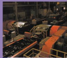
コールドピルガーミル Cold pilgering mill
